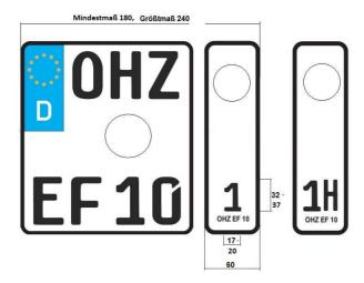
Die übrigen Abmessungen entsprechen denen der Kraftradkennzeichen.
